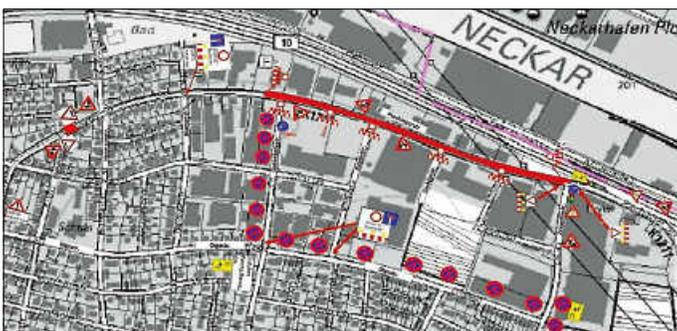
Der Ablauf der Straßenbauarbeiten ist wie folgt vorgesehen: **Ab Montag, 09.09.2024 wird eine Umleitungsstrecke eingerichtet.** Hierbei wird der innerörtliche Verkehr über die Zeppelinstraße und Olgastraße umgeleitet. Anschließend werden im Sanierungsbereich die Schachtabdeckungen ausgebaut und für den Asphaltbau vorbereitet sowie die Asphaltdeckschicht abgefräst.
