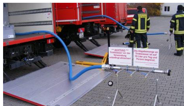
Abbildung 14: Trinkwasserausgabe bei der Feuerwehr (Bildquelle: Reuber, 2018)
