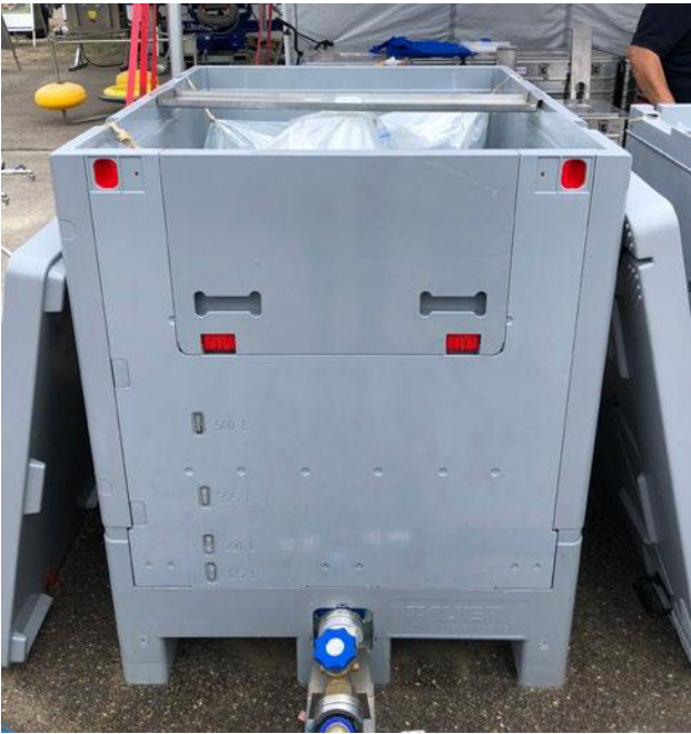
Abbildung 25: Speicherbehälter mit Einweg-Inlet (Bildquelle: SWA)
